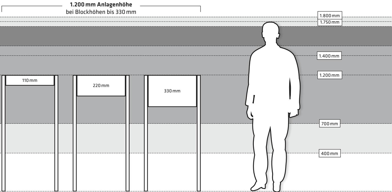
In Ausnahmefällen bzw. schwieriger Bausituation kann diese auch in einem Bereich zwischen 400 mm und 1.800 mm liegen.
