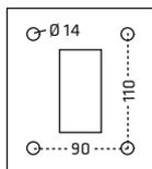
**S0441** Rechteckrohrständer zum Einbetonieren oder zum Aufschrauben mit Fußplatte; seitlich mit Kastenblock verschraubt; optionale Fußplatten geschweißt
