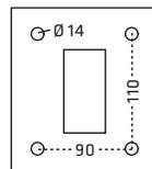
**S0440-2** Rechteckrohrständer zum Einbetonieren oder zum Aufschrauben mit Fußplatte; mit unterer Traverse; seitlich mit Kastenblock verschraubt; optionale Fußplatten geschweißt
