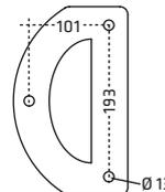
**S0460** halbovales Aluminium-Profilrohrgestell zum Einbetonieren oder zum Aufschrauben mit Fußplatte; seitlich mit Briefkastenanlage verschraubt; Abdeckkappen und optionale Fußplatten verschraubt
