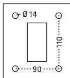
**S0440-1** Rechteckrohrständer zum Einbetonieren oder zum Aufschrauben mit Fußplatte; mit oberer und unterer Traverse; seitlich mit Kastenblock verschraubt; optionale Fußplatten geschweißt
