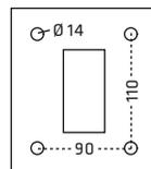
**S0440** Rechteckrohrständer zum Einbetonieren oder zum Aufschrauben mit Fußplatte; mit oberer Traverse auf Gehrung geschnitten und verschraubt; seitlich mit Kastenblock verschraubt; optionale Fußplatten geschweißt
