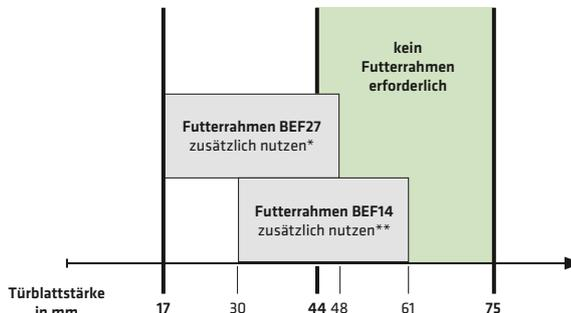
\* BEF27 muss zwingend genutzt werden, wenn die Türblattstärke zw. 17 und 30 mm misst. Bei Türblättern zw. 30 und 44 mm kann optional auch der schlankere Rahmen BEF14 genutzt werden. Im Bereich 44 bis 48 mm kann der BEF27 optional aus optischen Gründen genutzt werden.
